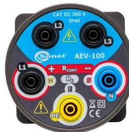
**Riso+ / Rcont+ / H / L1** – pomiar rezystancji izolacji / pomiar ciągłości / pomiar rezystancji uziemienia / podłączenie do przewodu fazowego badanego obiektu.
