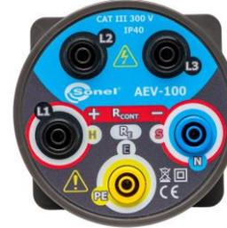
**R<sub>ISO+</sub> / R<sub>CONT+</sub> / H / L1** – Isolationswiderstandsmessung / Durchgangsmessung / Erdungswiderstandsmessung / Anschluss an die Phase des zu prüfenden Objekts.
